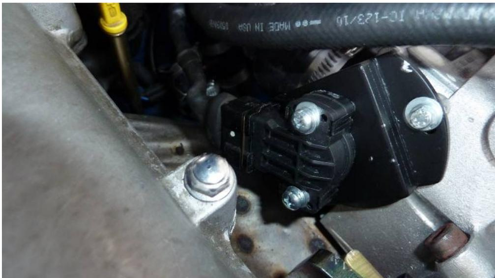
Der Drehwinkelsensor und die Adapterplatte sind so zu montieren, dass bei geschlossener als auch bei geöffneter Drosselklappe der Sensor nicht am Anschlag, sondern in beiden Drosselklappen-Positionen gleich vom Anschlag entfernt – sprich ausgemittelt – ist.
