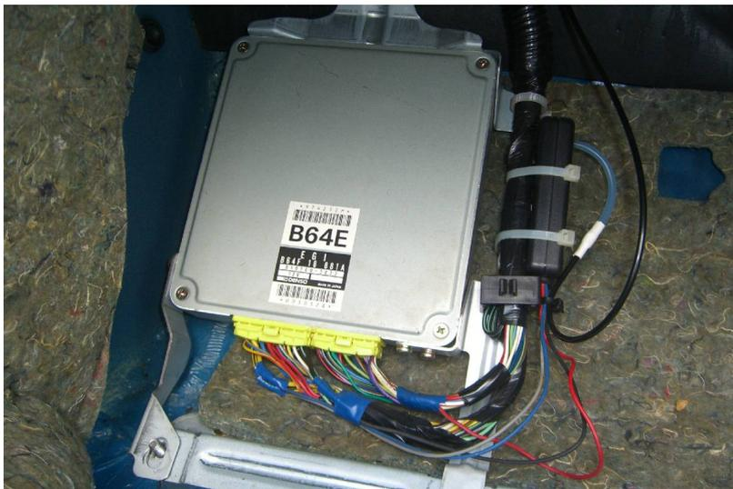
Nach dem man die beiden Kombistecker abgezogen hat, kann man das Motorsteuergerät entfernen. Um die MSPNP zu befestigen, habe ich mich zu einer beweglichen Halterung entschlossen. Diese sollte in der Lage sein die Stoß- und Rüttelbewegungen der Karosserie weitestgehend aufzunehmen. Auch sollte die MSPNP einen Mindestabstand vom Bodenblech besitzen, damit Kälte und Feuchtigkeit dem Gerät nichts anhaben können.
