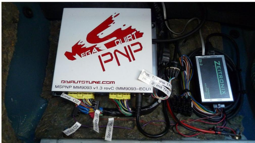
Anschluss der Zeitronix Breitbandsonde an die MS1-PNP (rechts TPS Umschalter):
