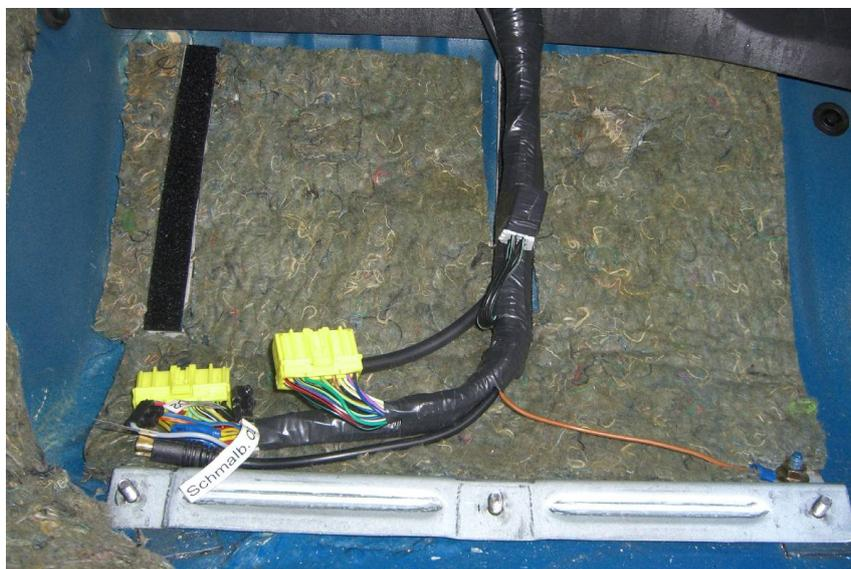
Jetzt muss noch der Druckschlauch verlegt werden. Die Verlegung erfolgt im ersten Bereich parallel mit dem Kabelbaum, dann durch eine vorhandene Öffnung in der Feuerwand bis zum freien Anschlussnippel an der Ansaugbrücke. Dort die Verschlusskappe abziehen und den Druckschlauch aufstecken. Den Schlauch noch an zwei, drei Stellen befestigen und darauf achten, dass diese nicht den Schlauch ab-/zudrücken.
