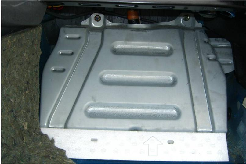
Nach dem die oberen beiden Muttern abgeschraubt sind, wenden wir uns der Styroporleiste zu. Diese lässt sich einfach abnehmen, da sie nur als Ausgleich aufgelegt ist. Darunter werden dann drei weitere Muttern sichtbar, die es zu entfernen gilt.
