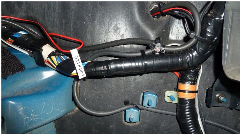
Kabel, Stecker und Schlauch auf festen Sitz prüfen. Zum Schluss noch das Abdeckblech, die Styroporleiste, den Teppich, die Einstiegsleiste und ggf. die Fußmatte wieder einbauen bzw. einlegen.
